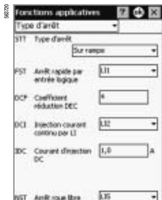
Конфигурирование типа остановки с помощью PowerSuite для КПК
