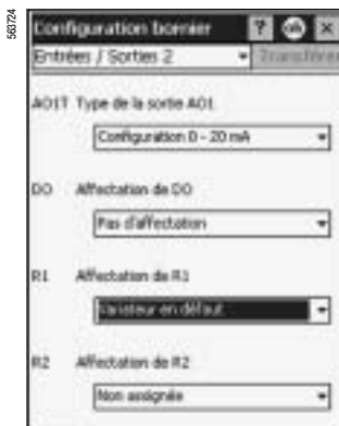
Конфигурирование реле неисправности с помощью PowerSuite для ПК
